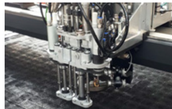
Système de perçage à double poinçon avec un diamètre allant de 5 à 25mm.
