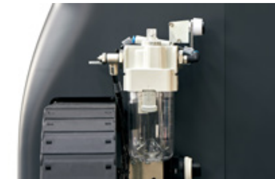
Système de refroidissement ou de lubrification de la lame selon les tissus.
