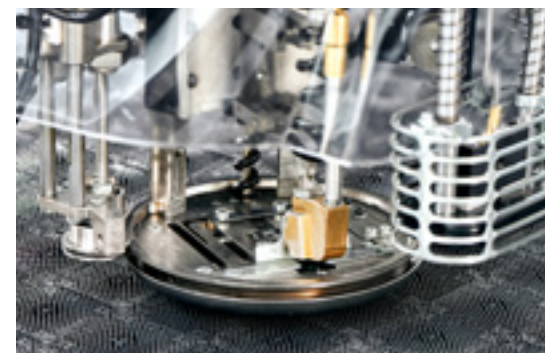
Dispositif de perçage équipé de contrôle de température avec foret ou poinçon.
