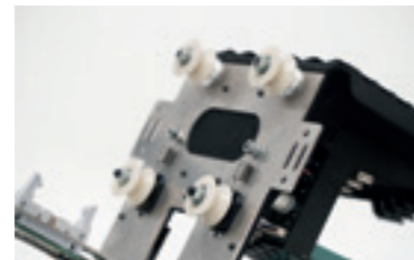
CARRO DEL CABEZAL: autónomo, fluido, guía cuádruple innovadora.
